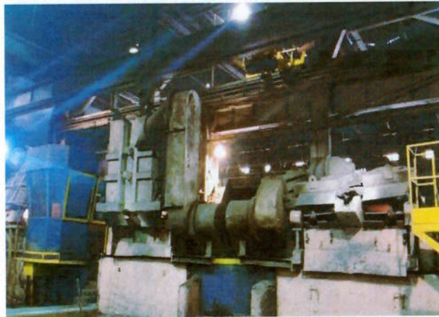
Figura 9 - Forno a indução utilizado para fundir e preparar a carga metálica antes do vazamento do metal líquido.
