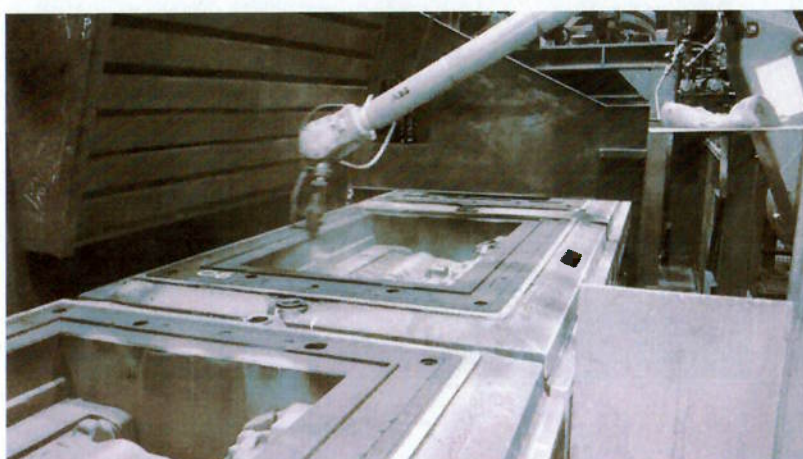
Figura 6 - Produção do molde inferior em areia verde, na linha de moldagem da Fundição em estudo.
