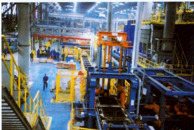
Figura 5 - Modelo de linha de Moldagem horizontal, da Fundição em estudo, utilizada para produção de blocos de motor em ferro fundido.
