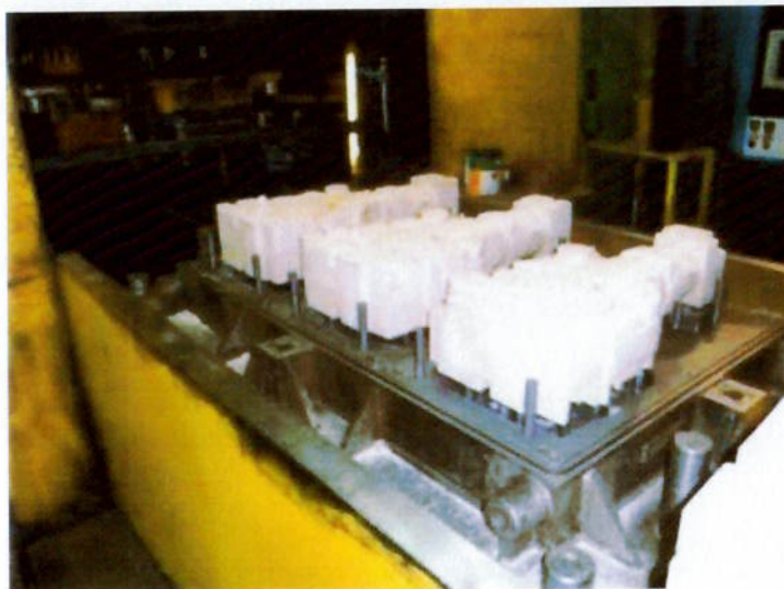
Figura 3 - Exemplo de caixa de macho inferior utilizada na produção de macho de areia.
